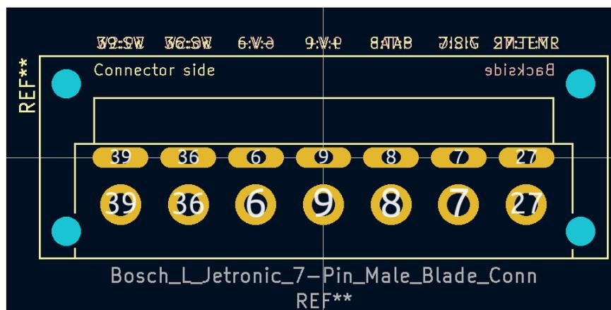
Abbildung 70: Footprint des Steckers zum Motorsteuergerät
