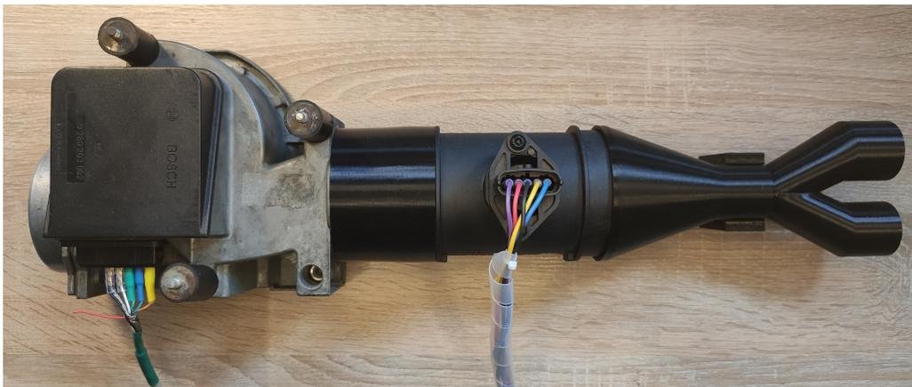
Abbildung 11: Messaufbau Rohdatenaufnahme mit 3D-gedruckten Teilen
