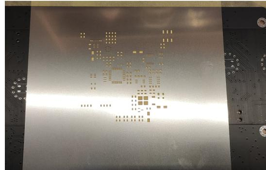
Abbildung 80: Schablone zum Aufbringen der Lötpaste
