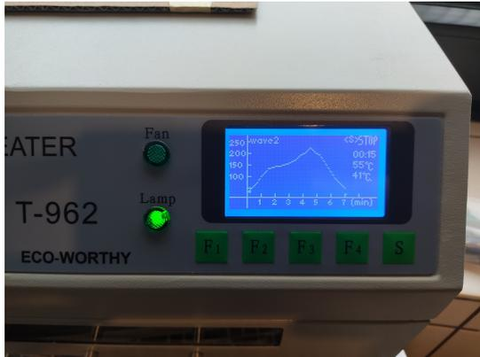
Abbildung 83: Temperaturkurve des Reflow-Ofens
