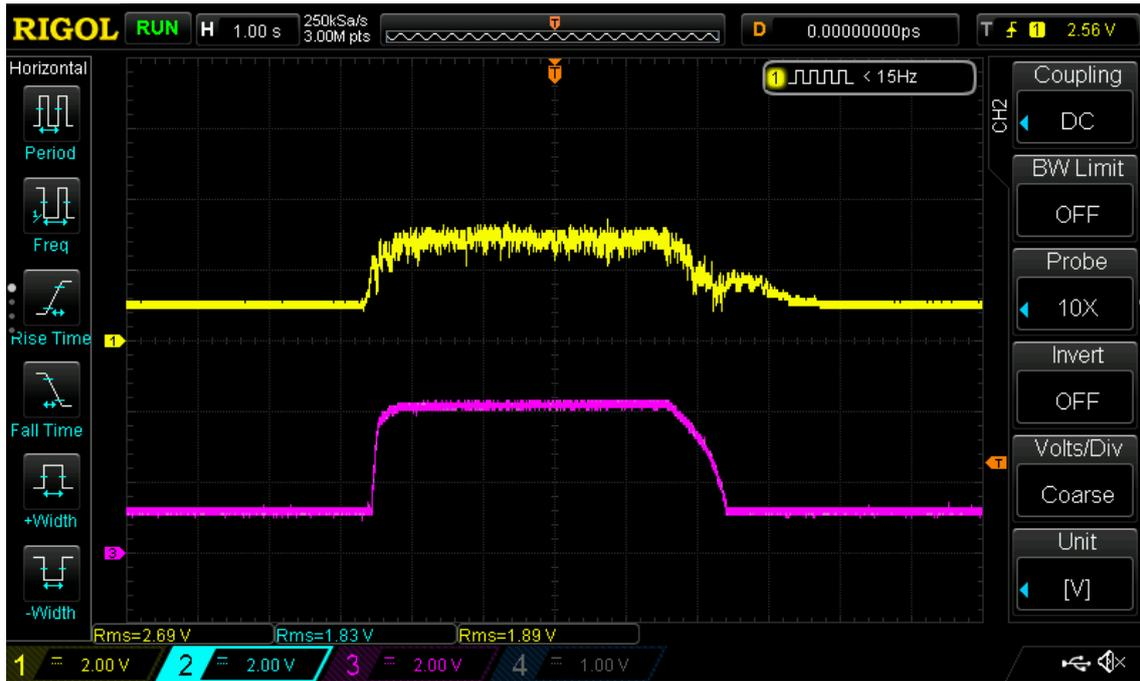
Abbildung 101: Ausgangssignale des mech. und el. LMMs (Kanal 1: Ausgang des el. LMMs)
